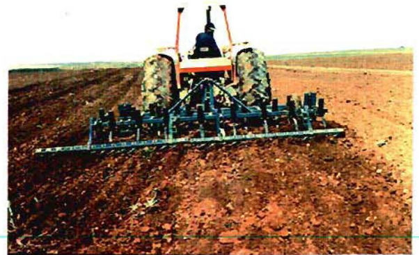
12 Cultivateur à dents souples pour préparer le lit de semences Cultivador com dentes flexíveis (speed tiller) para preparar o leito das sementes
