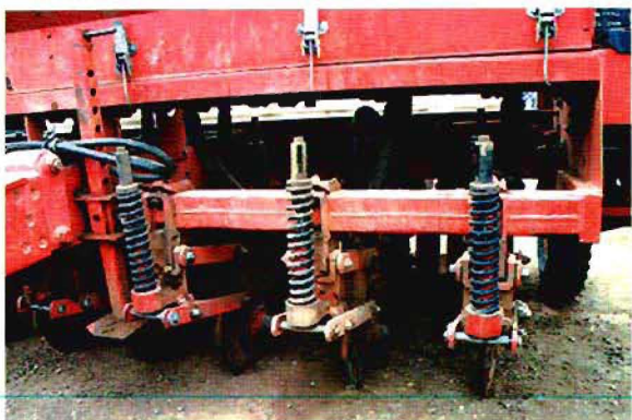
23 Double disque ouvreur pour semis direct Disco duplo para abrir a sulco de plantio no plantio direto
