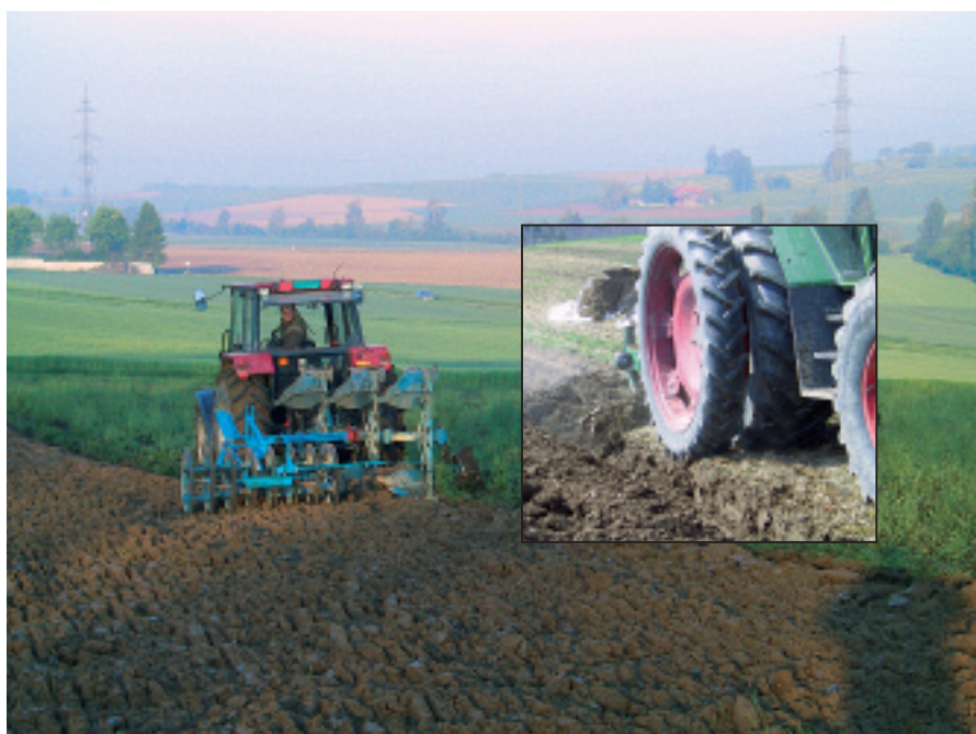
Fig. 9. Si le sol est labouré, la charrue ne devrait pas travailler à plus de 15 cm de profondeur et elle devrait être combinée avec un rouleau packer pour la préparation du lit de semence. La couche supérieure du sol, complètement colonisée par les racines, se défait facilement. De cette façon, le besoin en énergie est fortement diminué. Dans le système «ONLAND» (en médaillon), les (doubles) roues circulent en dehors de la raie de labour. La pression au sol est mieux répartie, ce qui réduit massivement les atteintes physiques causées par le passage du tracteur.
